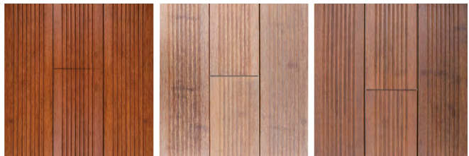
Nuevo Después de 16 meses en exteriores Después del mantenimiento
